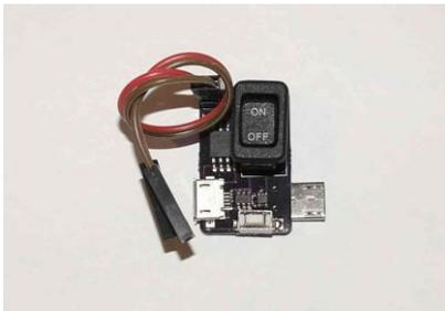
Wird der Schalter betätigt, fährt der Raspberry ordnungsgemäß herunter und die Spannungsversorgung wird komplett unterbunden.
